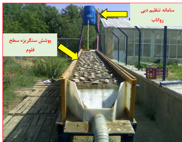
شکل ۱- تصویری از فلوم آزمایشی مورد استفاده Fig.1. General view of the experimental flume
