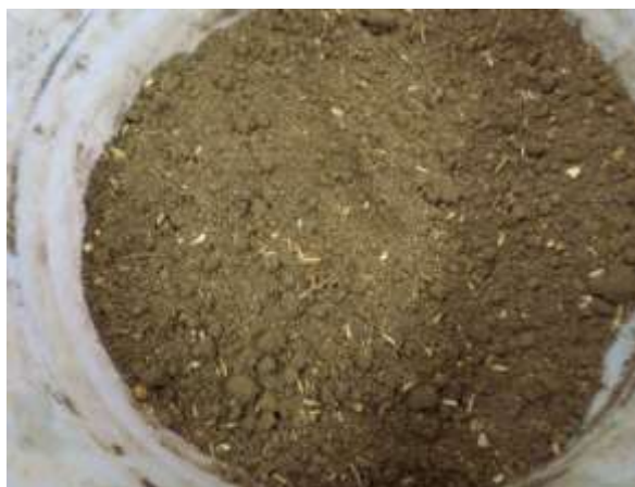
شکل ۱- مخلوط مالچ و خاک و تست پراکتور
