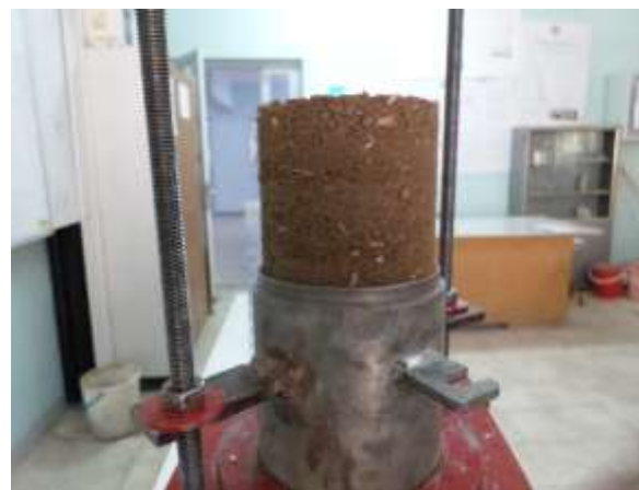
شکل ۱- مخلوط مالچ و خاک و تست پراکتور
