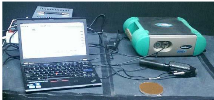
شکل ۱- تصویری از وسایل اندازه‌گیری انعکاس طیفی خاک در تاریک خانه، دستگاه FieldSpec@3 و ابزارهای آن و نمونه خاک آماده شده در پتری‌دیش
