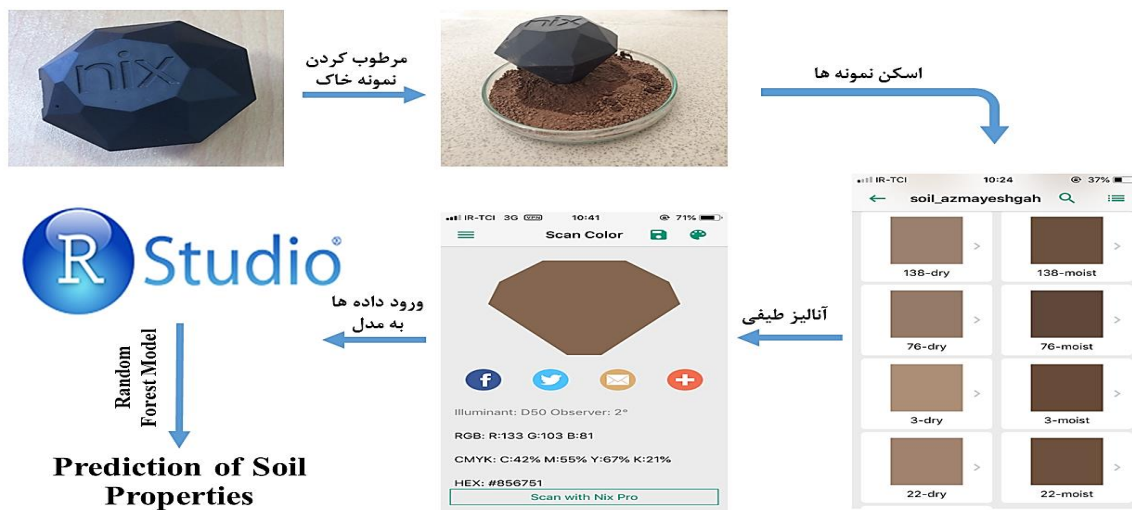
شکل ۲- نمودار نحوه عملکرد حسگر اسکن رنگ نیکس پرو برای برآورد خصوصیات خاک
