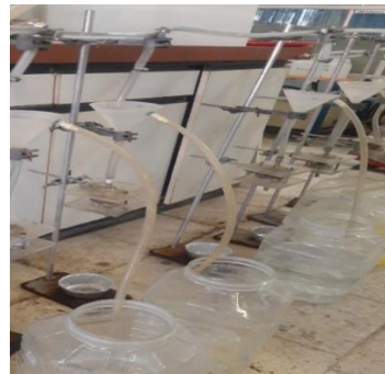
شکل ۳- اندازه‌گیری هدایت هیدرولیکی اشباع با روش بار ثابت
