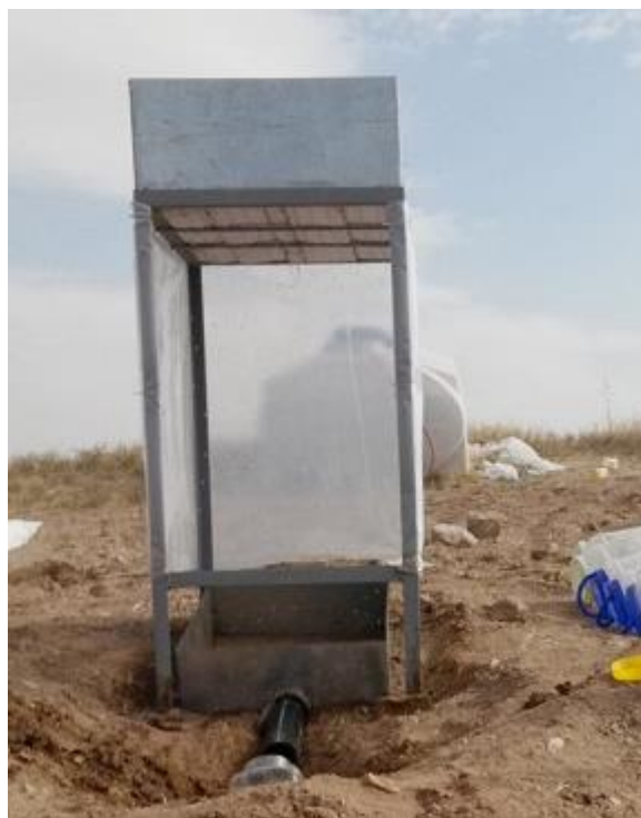
شکل ۱- نمایی از دستگاه شبیه‌ساز باران و فلوم فرسایشی مورد استفاده Figure 1. A view of the used a rain simulator and erosion flume
