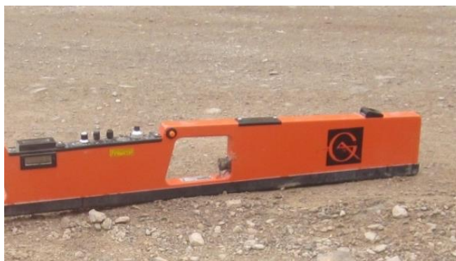
شکل ۲- دستگاه القاگر الکترومغناطیس مورد استفاده در این پژوهش
